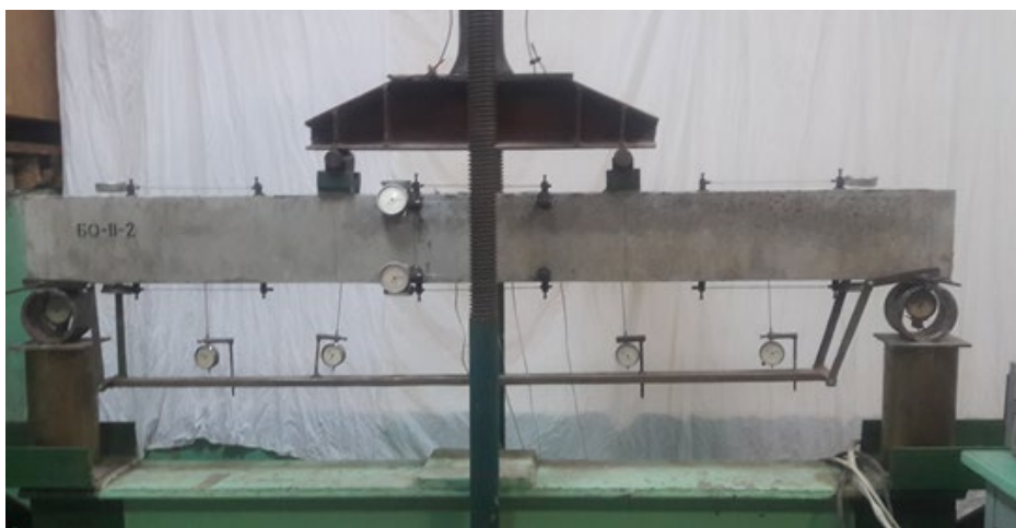
Рис. 6. Загальний вигляд випробування звичайної балки БО-II-2
