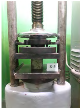
Рис. 2. Загальний вигляд випробування куба бетону
