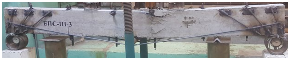
Рис. 5. Характер руйнування залізобетонної балки БПС-III-3
