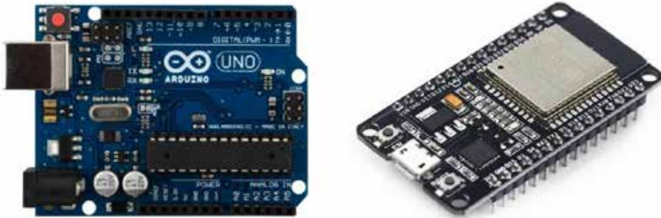
Рис. 7. Інтегровані у систему плати: а – Arduino Uno; б – Мікроконтролер ESP32 Development Board WiFi
