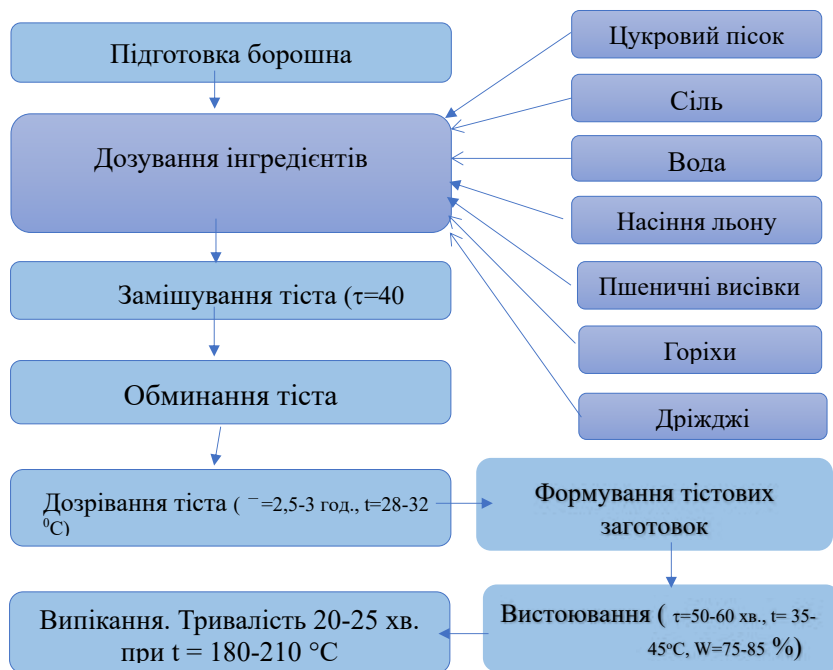
Рис. 1. Технологічна схема виробництва багетів збагачених функціональними інгредієнтами
