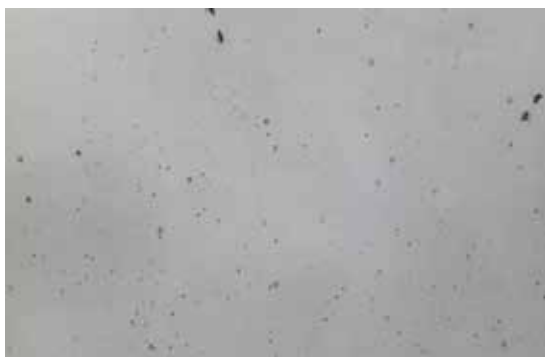
Рис. 4. Поверхня діодної структури, виготовленої з використанням гетерування
