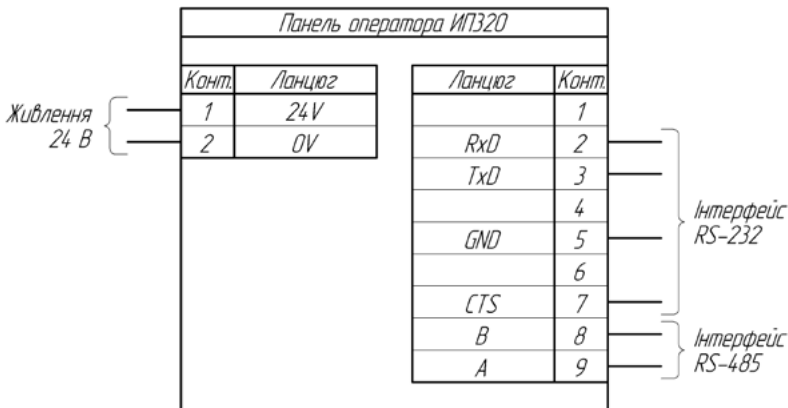
Рис. 2. Схема електрична під'єднання панелі оператора ИП320
