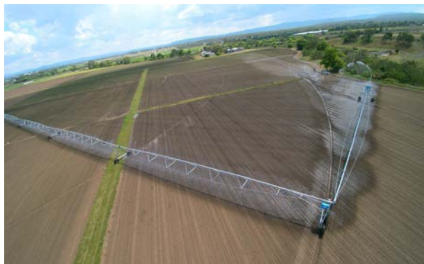
Рис. 6. Фактичне застосування схеми зрошення кутових ділянок під дощувальними машинами кругової дії
