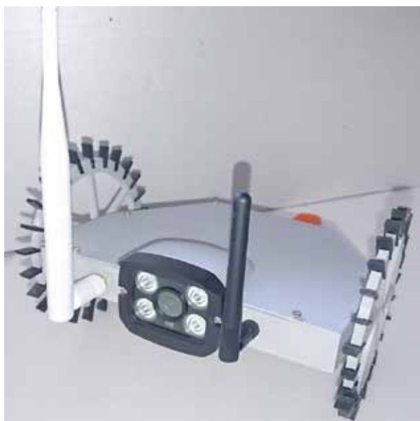
Рис. 2. Виготовлений прототип конструкції робототехнічної платформи з камерою відеоспостереження
