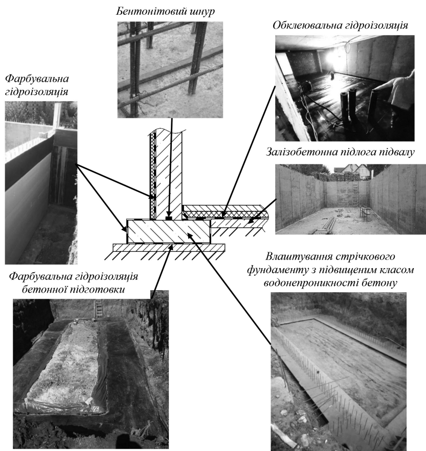
Рис. 5. Вузол влаштування гідроізоляції огорожувальних конструкцій підвалу
