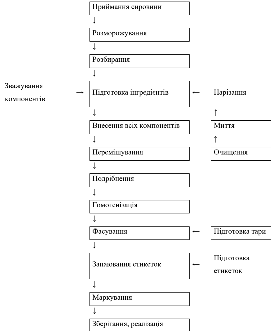
Рис. 3. Технологічна схема виготовлення мусів
